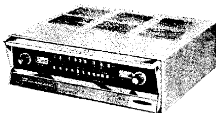
Fig. 1. - Sintonizzatore stereo Mod. AJ-43, Heathkit, completamente a transistori.
